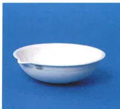
Odpařovací miska polohluboká Evaporating dish, semideep Halbtiefe Abdampfschale Cápsula de evaporación forma media, fondo plano Выпа́рн я чак а полуглубокая, куглодонная
