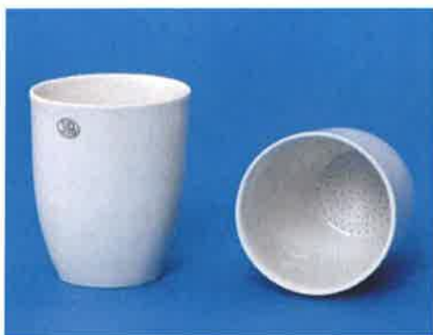
Kelímek Goochův Gooch crucible Gooch Filterstiegel Crisol Gooch de filtrar Тигель Гooxa
